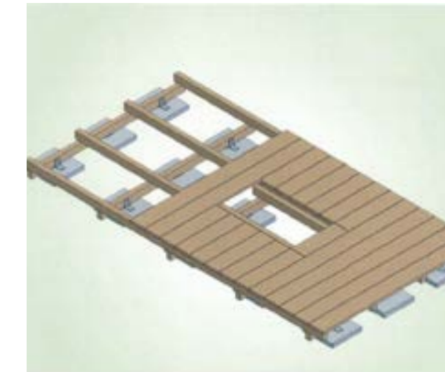
Umrandungen und Revisionsklappen müssen bei der Planung der Unterkonstruktion schon eingeplant werden.
