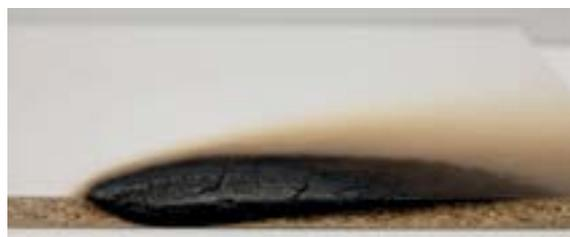
Sezione di Eurodekor dopo 30 minuti di combustione
