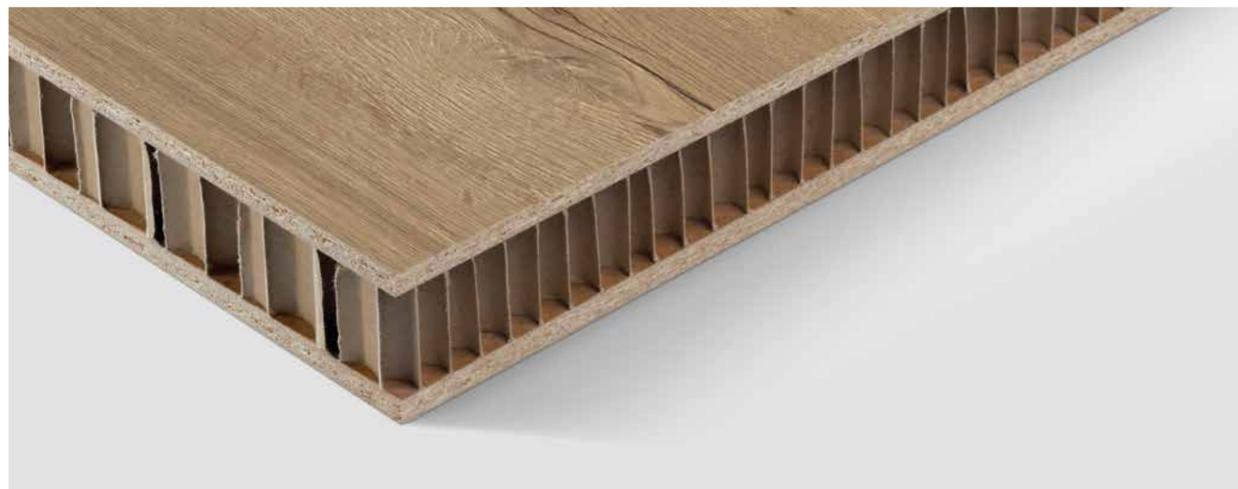
I pannelli tamburati Eurolight sono pannelli compositi costituiti da strati di materiale a base di legno che racchiudono un'anima di cartone leggero a nido d'ape. Grazie al loro peso ridotto e alle buone caratteristiche di stabilità offrono una vasta gamma di possibilità di progettazione e costruzione nell'arredamento e nel design d'interni.
