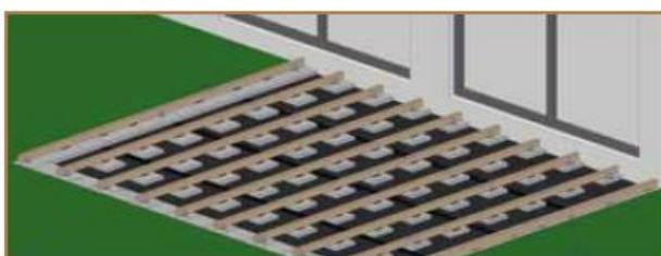
7. Befestigen Sie jede Unterkonstruktion z.B. mit Metallwinkel und Schrauben mindestens 3-mal (vorne - Mitte - hinten) auf den Betonplatten.
