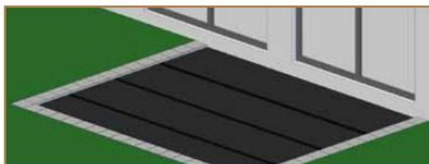
5. Unter jede Unterkonstruktion sollten bei 25mm starken Massivholzdielen am besten Betonplatten von 4x20x20cm mit ca. 50cm Abstand (Mitte - Mitte) gelegt werden. Bei 21mm starken Terrassendielen sollte der Abstand ca. 45cm betragen. Bei NFC/WPC/RMC-Produkten und bei modifizierten Materialien beachten Sie immer die Herstellerangaben.
