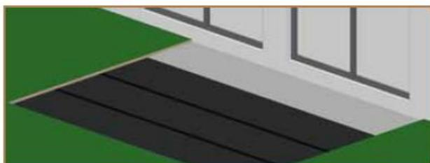
2. Der Untergrund sollte aus einem wasserdurchlässigen Bodenaufbau nach DIN 18130-1 und 18533 bestehen und ausreichend verdichtet sein. Optimal ist z.B. eine ca. 15cm starke Tragschicht (Korn 0-45) ohne Bindemittel (Nutzungsgruppe N1 nach der ZTV-Wegebau).
