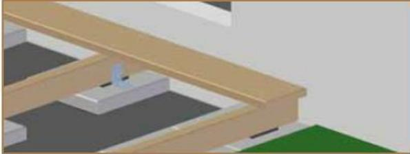
10. Die Schrauben sollten ca. 2,5-mal so lang sein wie die Dielen stark sind. Pro Brett müssen mindestens 2 Verschraubungen auf jeder Unterkonstruktion erfolgen. Der Abstand der Schrauben sollte ca. 100mm bei einer Brettbreite von 145mm betragen.
