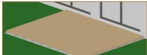
13. Die letzte Terrassendiele sollte ca. 10mm über die vordere Verblendung überstehen. Das Blendl Brett sollte mindestens 1-mal an jede Unterkonstruktion befestigt werden.
