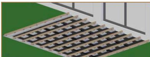
7. Fissate ogni elemento della sottostruttura alle lastre di cemento utilizzando, ad esempio, staffe angolari in metallo e viti, in almeno in tre punti (estremità - centro - estremità).
