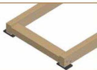
9. Zur guten Belüftung und zur Vereinfachung von Pflege- und Wartungsarbeiten sollte der Abstand zu Mauern und anderen Bauteilen mindestens 20mm betragen. Die Terrassendielen sollten am Ende ca. 10-20mm überstehen und zusätzlich an den Kopfenden gefast oder gerundet werden.
