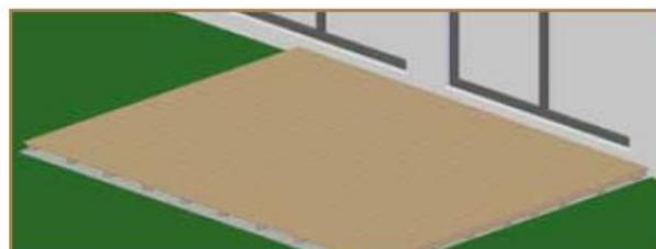
13. Die letzte Terrassendieli sollte ca. 10mm über die vordere Verblendung überstehen. Das Blendbrett sollte mindestens 1-mal an jede Unterkonstruktion befestigt werden.
