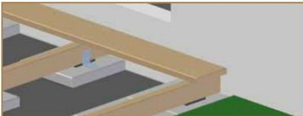
10. Die Schrauben sollten ca. 2,5-mal so lang sein wie die Dielen stark sind. Pro Brett müssen mindestens 2 Verschraubungen auf jeder Unterkonstruktion erfolgen. Der Abstand der Schrauben sollte ca. 100mm bei einer Brettbreite von 145mm betragen.
